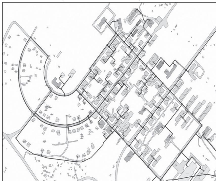
Рисунок 3. Схема расположения объектов водоснабжения п. Горный (35 квартал города Лесной)
